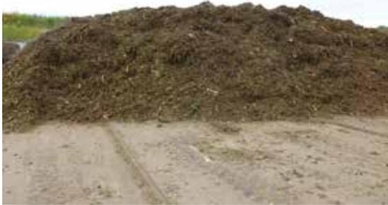
Les branchages et sacs passent tout d'abord au broyeur. Le broyat est mouillé et mis en tas longilignes, des andains, d'environ trois mètres de haut, disposés sur des surfaces percées de buses de ventilation forcée, une tout les 12 cm, qui apportent ainsi l'oxygène nécessaire
